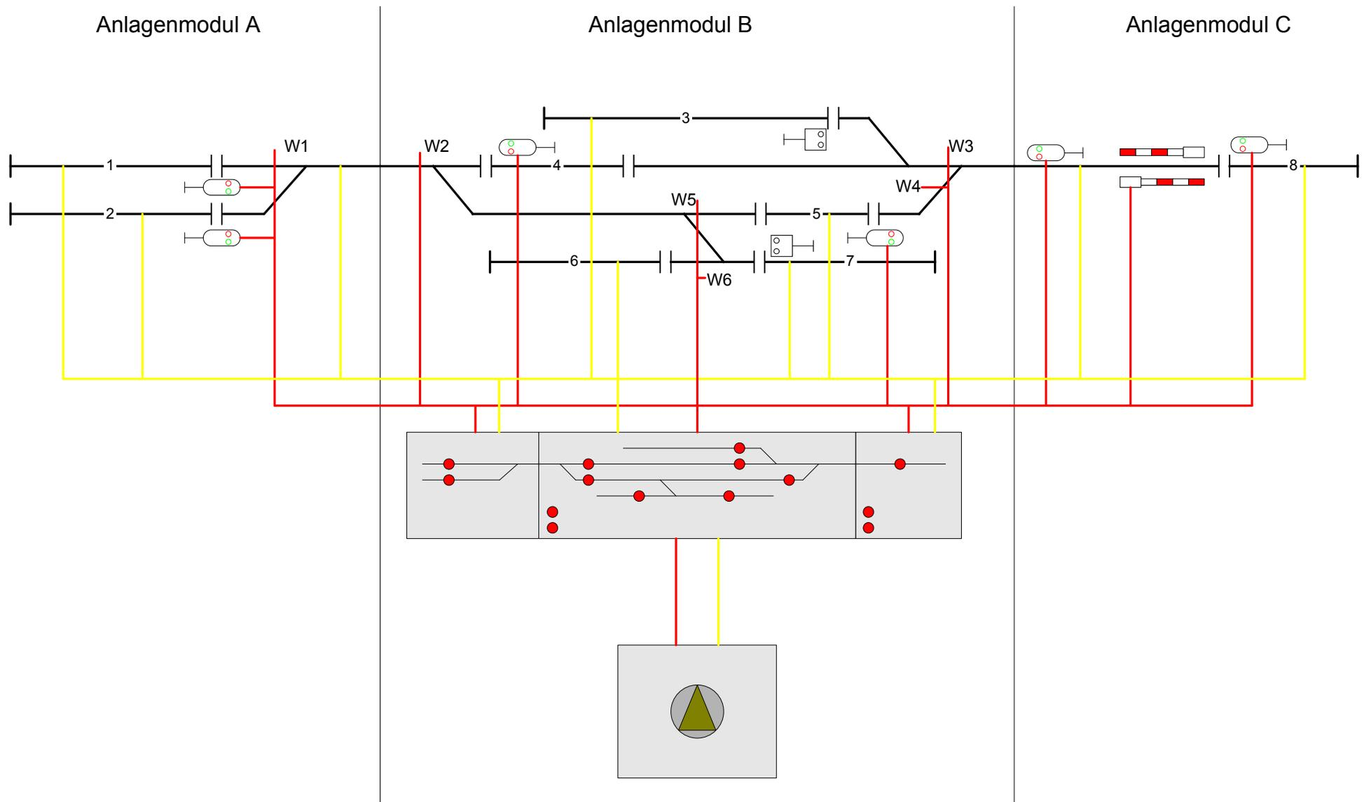
Beispiel einer Modulanlage mit einem zentralen Schaltpult.
