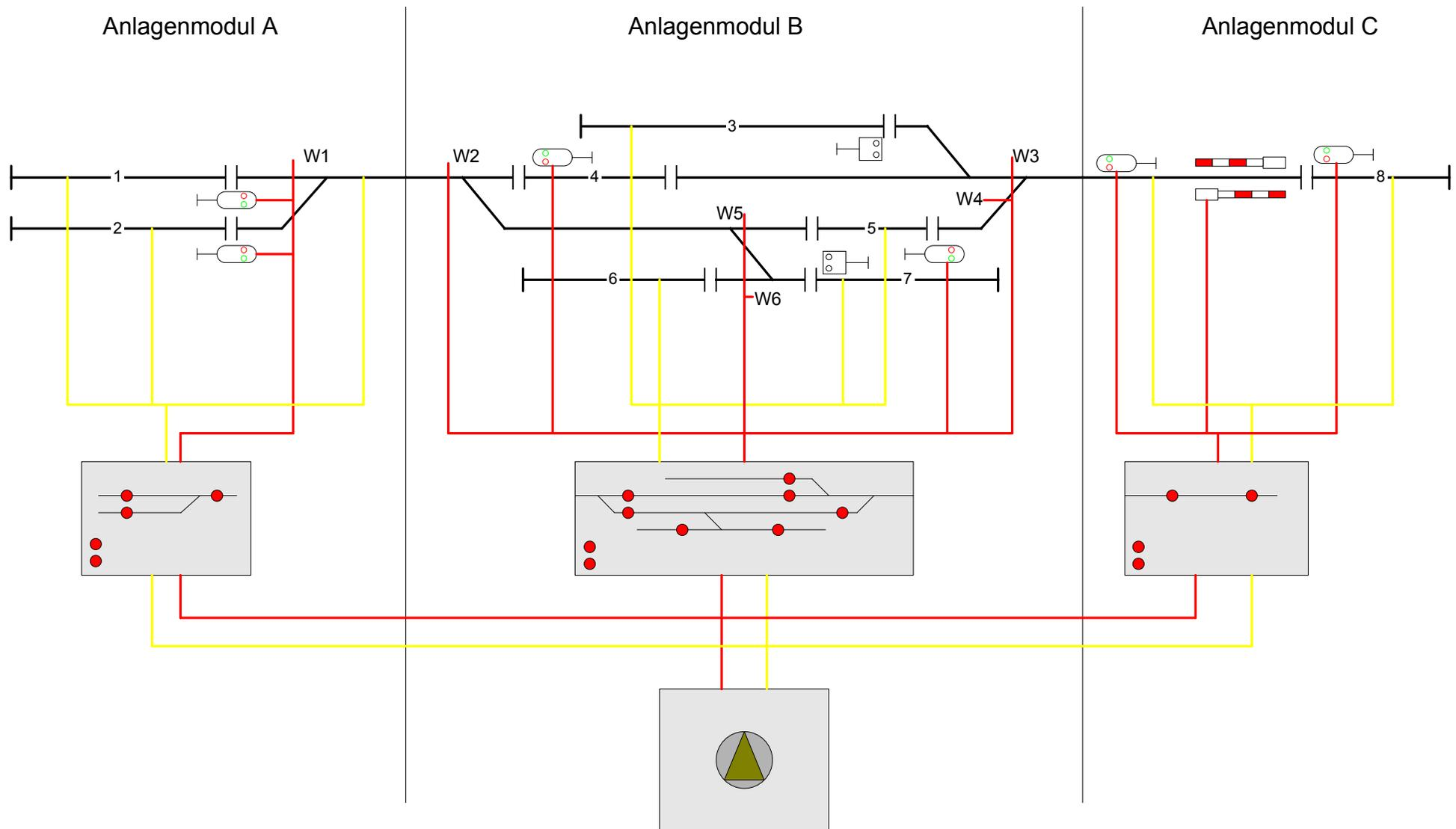
In diesem Beispiel hat jedes Anlagenmodul sein eigenes Schaltpult. Die Module sind elektr. nur über die gemeinsame Spannungsversorgung miteinander verbunden. Dies spart Kabel und Verbindungselemente.
